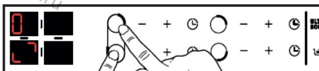
Для активации функции двойной варочной зоны Duozone нажмите одновременно на кнопки **-** и **+**, после чего на дисплее появляется символ **DZ**. Настройки мощности и таймера выполняются в обычном порядке с помощью кнопок управления задней варочной зоной. Кнопки управления передней зоной автоматически отключаются.
