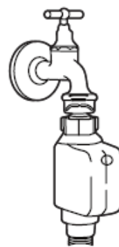
шланг подачи воды с системой безопасности
