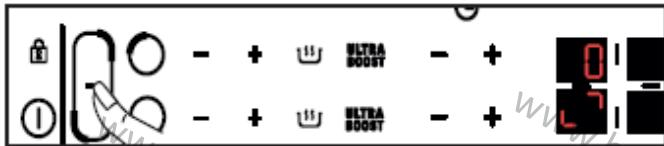
При нажатии на кнопку активируются одновременно передняя и задняя варочные зоны, за которые отвечает функция HORIZONE, а на дисплее появляется символ . Настройки мощности и таймера выполняются в обычном порядке с помощью кнопок управления задней варочной зоной. Кнопки управления передней зоной автоматически отключаются.
